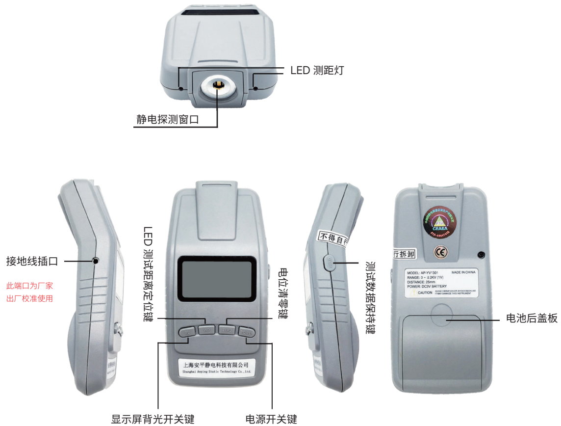
图1 AP-YF1301/02/03 静电电压检测表使用示意图
