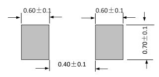
Recommended Pad Layout (mm) 建议焊盘布局(mm)
