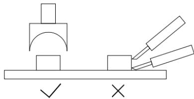
烙铁应使用如下图的方式作业。
