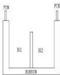
**绕线结构表 Winding Structure Diagram**
