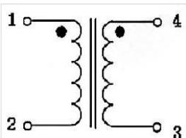
**绕线结构表 Winding Structure Diagram**
