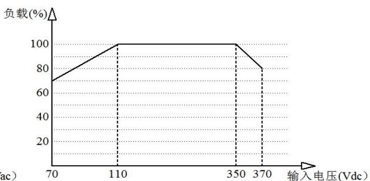
说明: 输入电压为 85V~110VAC/85-120VDC 时, 需要对模块进行降额使用。
