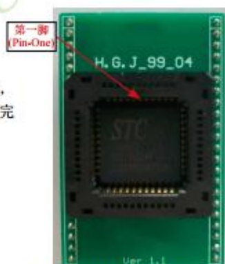
PLCC-44封装的单片机安装图
