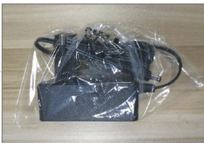
2. 产品放入PE袋 PE袋尺寸: L190*W120*T0.07mm
