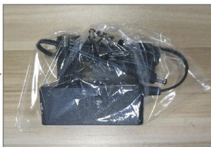
2. 产品放入PE袋 PE袋尺寸: L190*W120*T0.07mm
