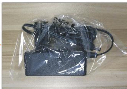
2. 产品放入PE袋 PE袋尺寸: L190*W120*T0.07mm
