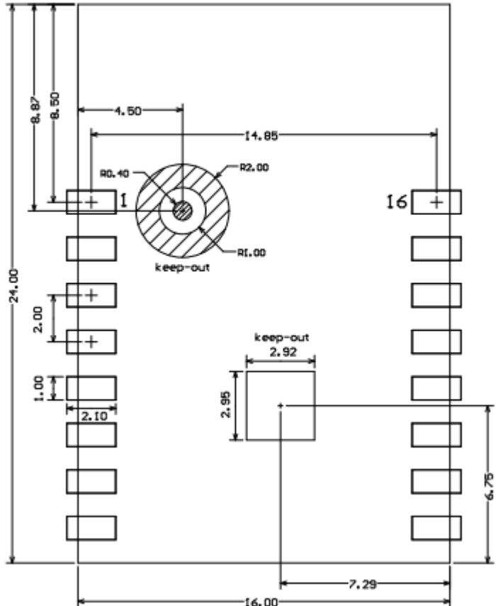
备注：默认的模组外形尺寸公差为  $\pm 0.35$  mm，关键尺寸公差  $\pm 0.1$  mm。关键尺寸如果客户有明确要求，请沟通后在规格书中进行明确的标定。
