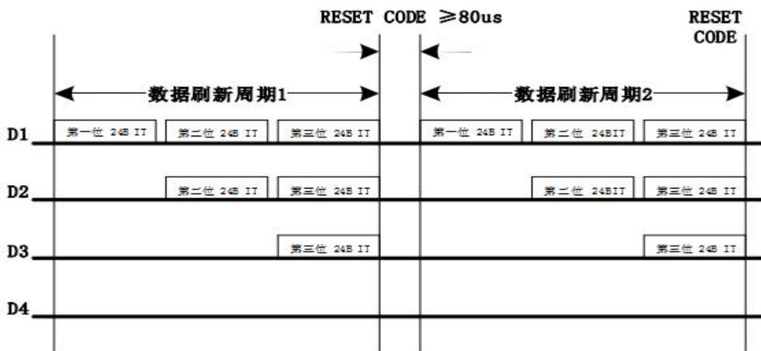
注: 其中 D1 为 MCU 端发送的数据, D2、D3、D4 为级联电路自动整形转发的数据。
