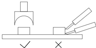
烙铁应使用如下图的方式作业。
