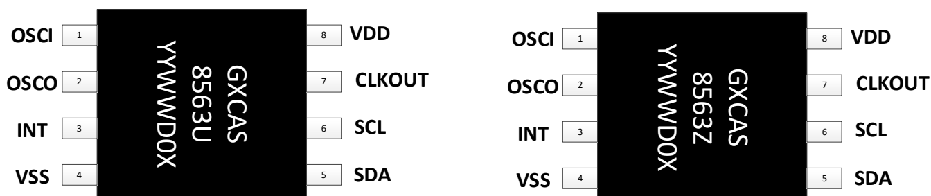
图 2. GX8563 的引脚配置情况
