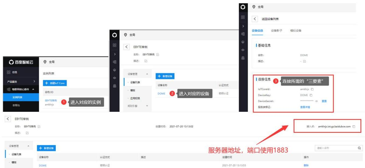
配置设备连接参数，如下图所示：
