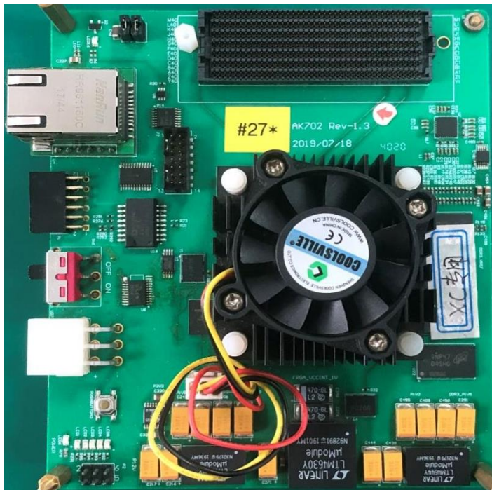
图 1：AK702 开发板 XC7K480T-2FFG1156I
