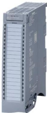
SIMATIC S7-1500, 模拟输入模块 AI 8xHART HF, 精确度 0.1%, 8 条通道, 每组 4 条, 共模电压: 30V AC/60V DC, 诊断; 硬件中断在 RUN 模式下校准; 供货范围内包含 馈电元素, 屏蔽支架 和屏蔽端子
