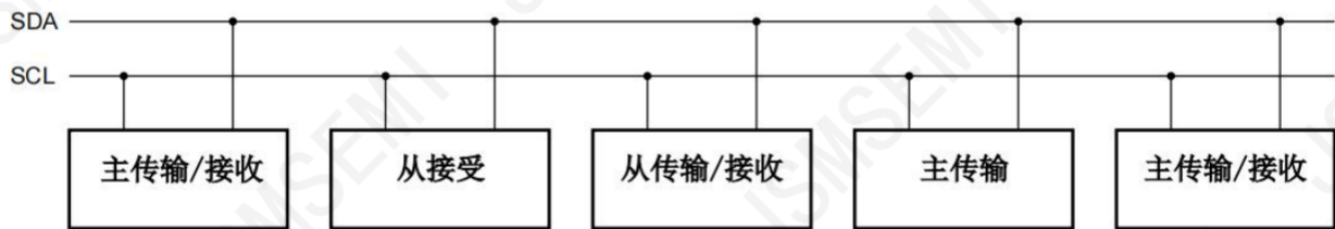
图 6 I 2 C 总线系统配置图
