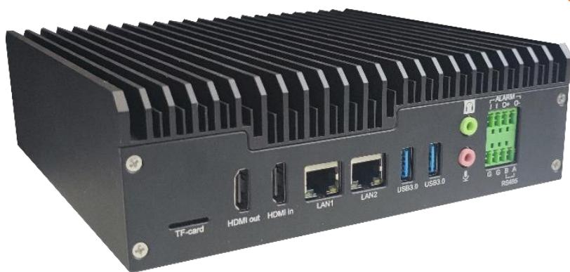
4 核 64 位 RISC-V 架构 CPU, Linux Debian 系统, 20Tops 算力 NPU
