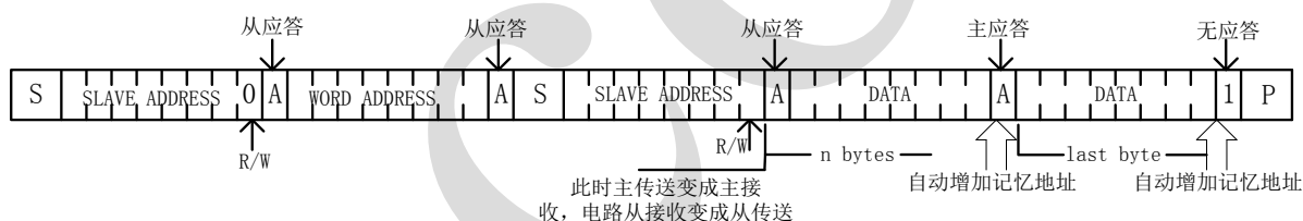
图 10、设置字地址后主设备读数据 (写字地址: 读数据)
