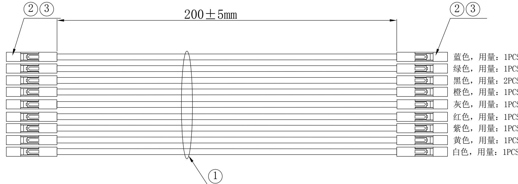
包装方式: 将以上用量线材一起用橡皮筋扎起来 (共10条线)。
