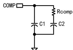
推荐参数配置： $R_{comp} = 33 k\Omega$ ， $C_1 = 150 nF$ ， $C_2 = 470 nF$ 。
