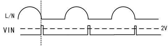
如上图，当输入电压接近 0V 时，DK3601A 启动外置 OTP 功能，此时 IC 内部为 VIN 引脚提供 200uA 的 source 电流，并检测 VIN 引脚电压，若 VIN 电压低于 2V，则触发 OTP 计数，若连续 4 次触发，芯片停止工作。
