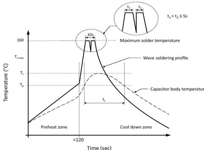
$T_s$ : 波峰焊接时电器本体最大受热温度
