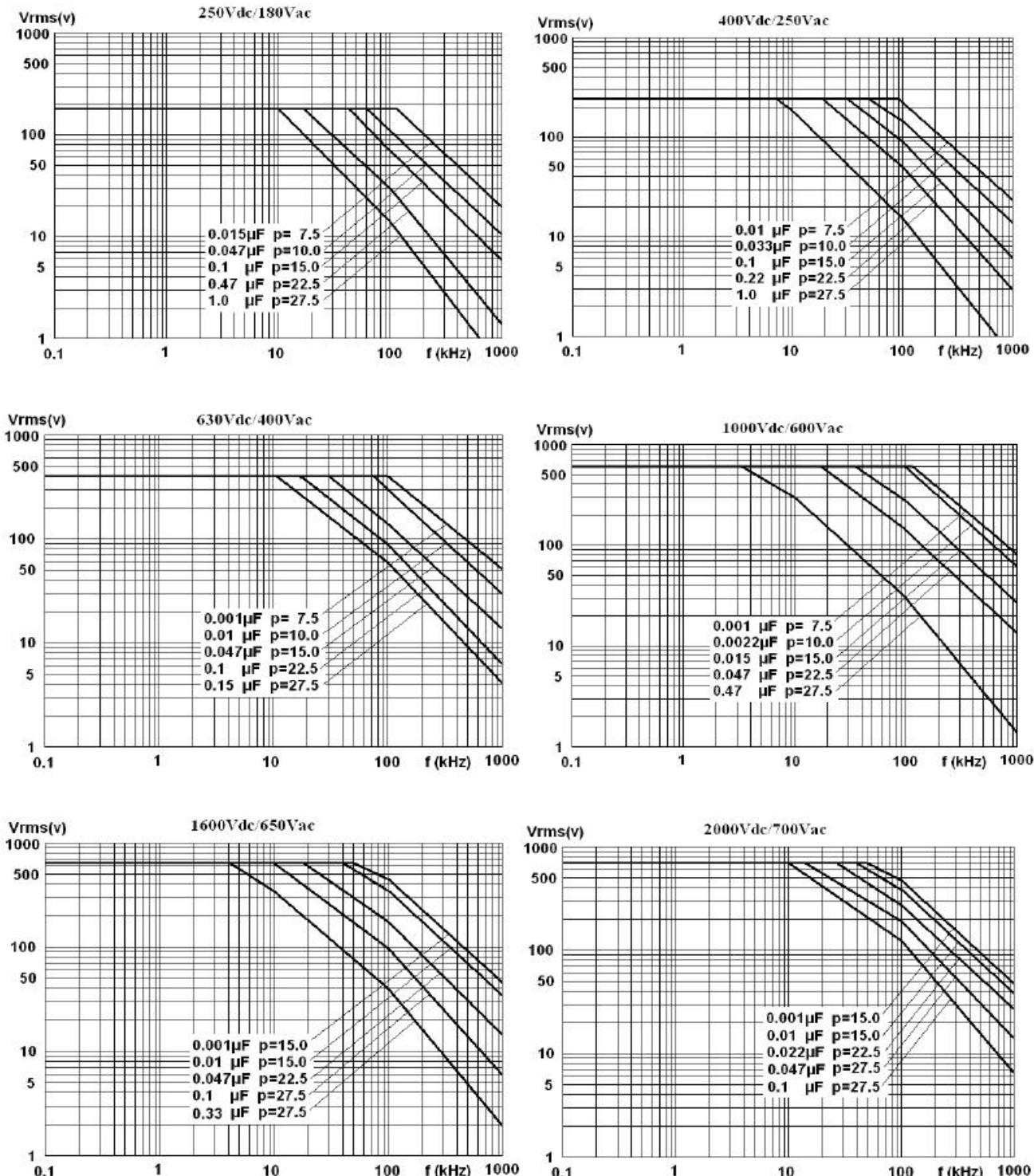
曲线图典型值在施压电压系正弦波形，环境温度≤85℃，电容器内部温升△T=10℃条件下试验。
