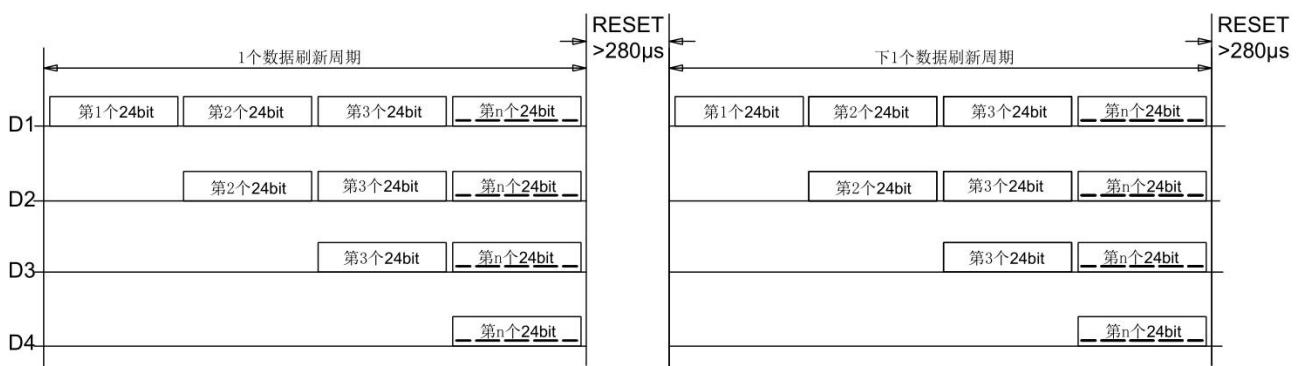
注: 其中 D1 为 MCU 端发送的数据, D2、D3、D4 为级联电路自动整形转发的数据。
