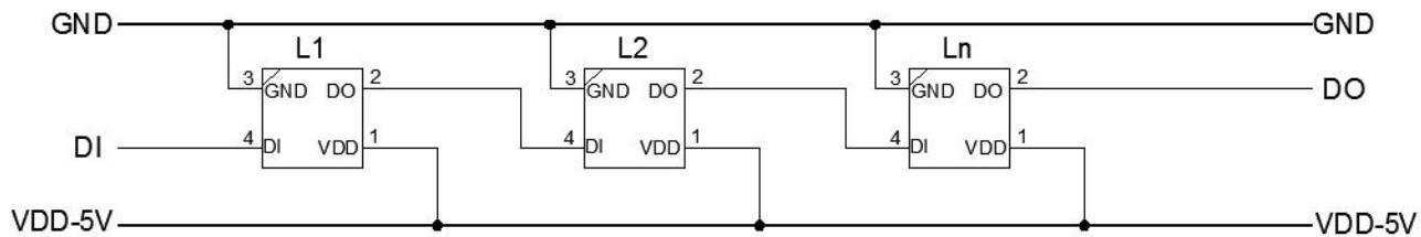
在长距离使用时, 为了增加LED的稳定性, 需要在VDD和GND之间适当增加滤波电容。
