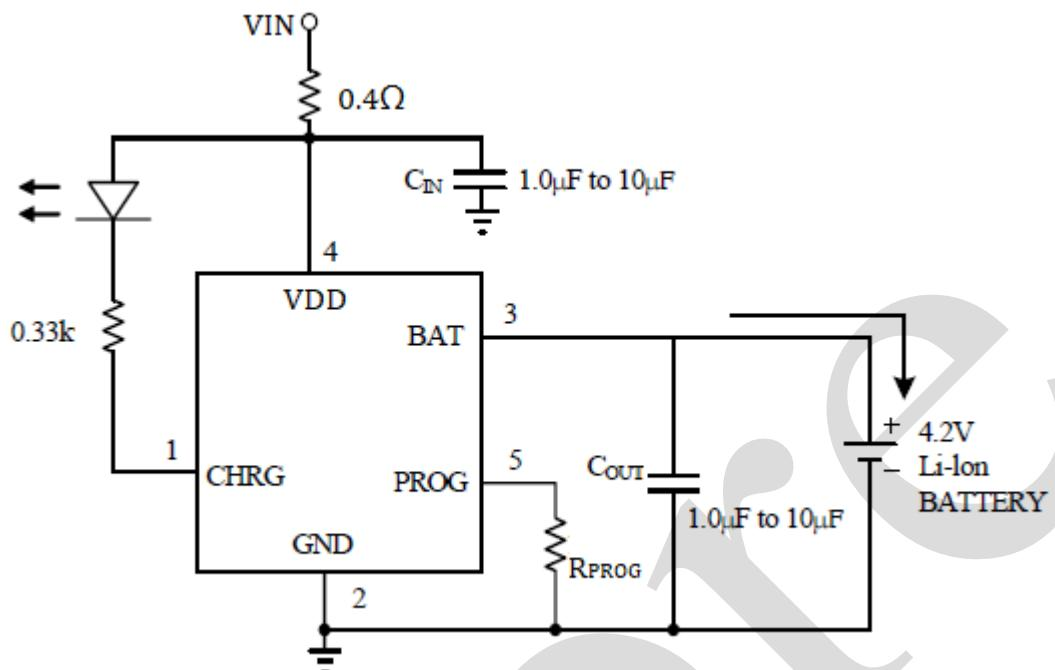
注：芯片 VDD 引脚与外部电源之间的串联电阻用于转移热功耗，可以减小芯片发热，小电流充电应用场景可不加。
