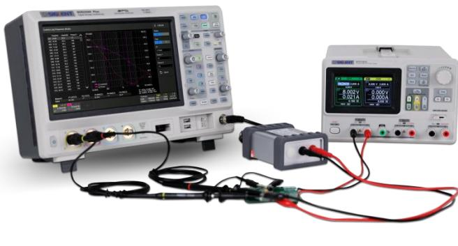
利用波特图测试系统的频率响应或环路稳定性，在一定领域取代昂贵的网络分析仪。可搭配内置波形发生器或外置 SDG 系列任意波形发生器。
