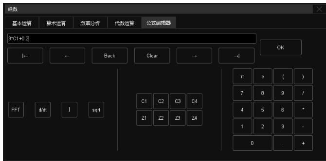
两条独立的 Math 波形，支持加法、减法、乘法、除法、FFT、微分、积分、平方根、相等、取反、绝对值、Sign、指数、对数、插值、平均和 ERES 运算，支持公式编辑器自定义运算表达式
