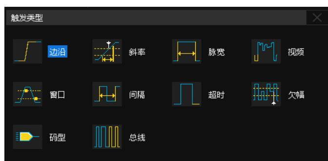
具有丰富的触发功能，包括边沿、斜率、脉宽、视频、窗口、间隔、超时、欠幅、码型和多种总线触发（即：串行触发）
