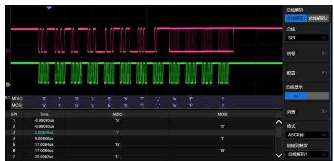
通过事件列表显示解码, 能快速、直观地将总线的协议信息以表格形式显示。支持 I2C, SPI, UART, CAN, LIN, CAN FD, FlexRay, I2S, MIL-STD-1553B, SENT 和 Manchester 等多种协议。
