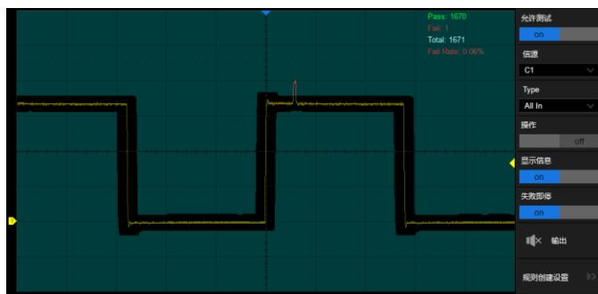
基于硬件的模板测试功能, 最高每秒可执行 80,000 次测试。根据用户自定义的垂直和水平容限生成模板, 比较被测信号是否触碰模板, 如果被测信号触碰模板则测试失败, 可以预先设定测试失败时采集停止以及蜂鸣器告警, 将失败帧自动截图或存入历史帧, 适用于长期无人值守监测异常信号。
