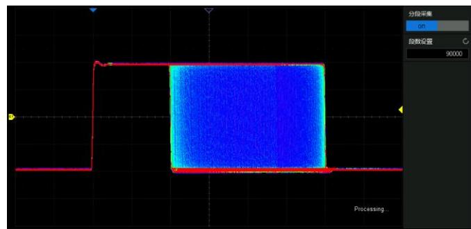
分段采集将波形储存空间分成多段，每段空间存储一个触发帧，最大可以采集 90,000 个触发事件，在 Sequence 周期内可最大限度地降低触发事件之间的间隔时间（小至 2μs），提高对异常事件的捕获概率。Sequence 模式下采集的所有波形段可以一次性全部映射到屏幕上，也可以通过 History 进行单帧回放
