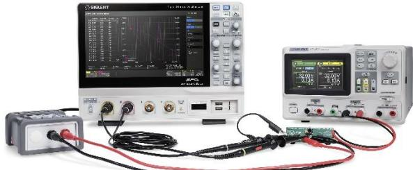
利用波特图测试系统的频率响应或环路稳定性，在一定领域取代昂贵的网络分析仪。可搭配波形发生器选件或 SDG 系列任意波形发生器
