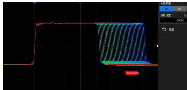
分段采集将波形储存空间分成多段，每段空间存储一个触发帧，最大可以采集 80000 个触发事件，在 Sequence 周期内可最大限度地降低触发事件之间的间隔时间（小至 2.5μs），提高对异常事件的捕获概率。Sequence 模式下采集的所有波形段可以一次性全部映射到屏幕上，也可以通过 History 进行单帧回放
