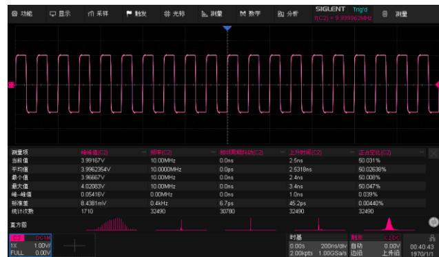
参数统计功能可显示任意参数的五种测量值：当前值、平均值、最小值、最大值、标准差；最多可同时测量统计 12 种不同的参数。直方图统计可以直观地显示参数的概率分布情况；趋势图和轨迹图可反应参数随时间的变化规律。
