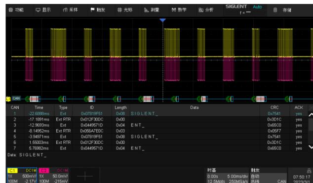
通过事件列表显示解码，能快速、直观地将总线的协议信息以表格形式显示。支持 I<sup>2</sup>C、SPI、UART、CAN、LIN多种协议
