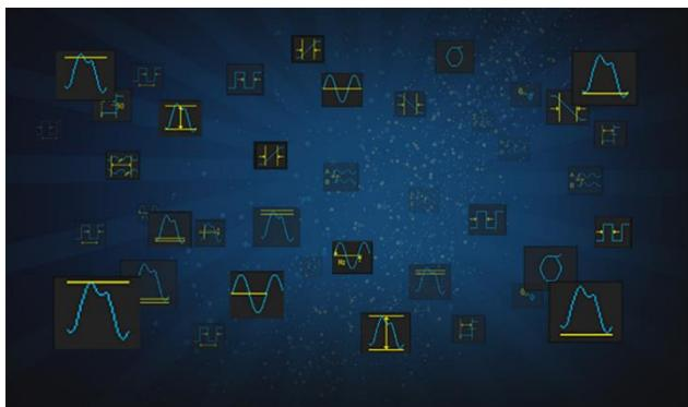
测量类型包括水平类、垂直类、通道间延时类和混合测量类共超过 50 种参数。测量源包括模拟通道、数字通道、数学运算、参考波形、历史帧等
