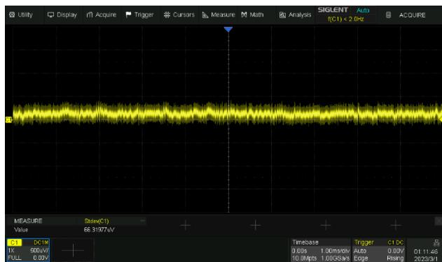
优秀的本底噪声性能，在200 MHz全带宽下的底噪值仅为70  $\mu$ Vrms，让12-bit ADC充分发挥性能
