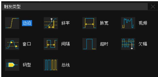
具有丰富的触发功能，包括边沿、斜率、脉宽、视频、窗口、间隔、超时、欠幅、码型和多种总线触发（串行触发）
