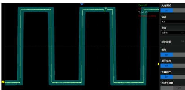
基于硬件的模板测试功能，最高每秒可执行 70000 次测试。根据用户自定义的垂直和水平容限生成模板，比较被测信号是否触碰模板，如果被测信号触碰模板则测试失败，可以预先设定测试失败时采集停止以及蜂鸣器告警，将失败帧自动截图或存入历史帧，适用于长期无人值守监测异常信号
