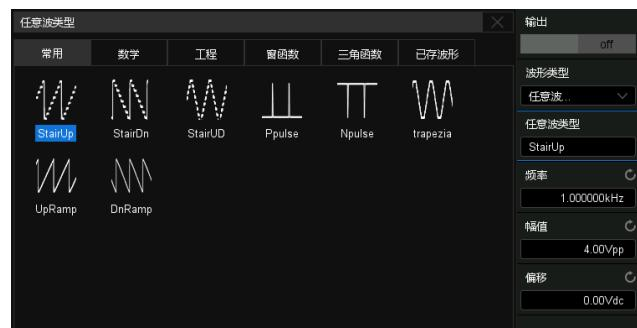
通过 USB Host 接入 25MHz USB 任意波形发生器模块，集成正弦波、方波、三角波、脉冲波、噪声、直流以及 45 种内建任意波，用户也可通过 EasyWave 上位机软件编辑任意波形。
