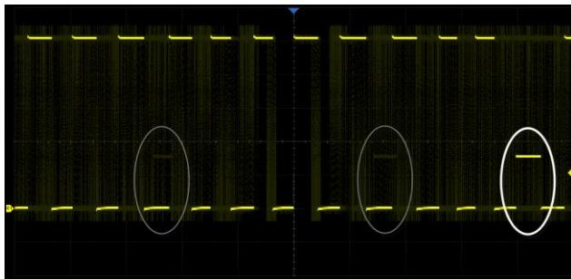
正常模式下100000帧/秒，Sequence 模式下400000帧/秒的波形刷新率，使示波器能轻松捕获到低概率异常事件
