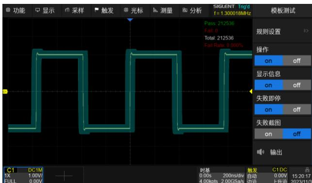
基于硬件的模板测试功能，最高每秒可执行 80000 次测试，适用于长期无人值守监测异常信号
