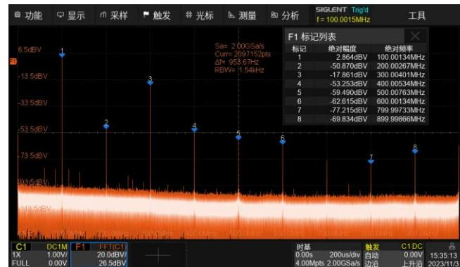
通过硬件加速的 FFT 功能，最大运算点数为 2M 点，在提供优越的频谱分辨率的同时，仍然能够保持较高的频谱刷新率。支持多种窗函数，支持普通、平均、最大值保持等模式，支持自动标记峰值点
