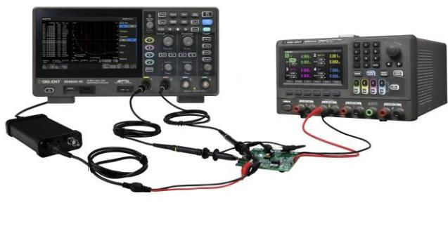
利用波特图测试系统的频率响应或环路稳定性，在一定领域取代昂贵的网络分析仪。可搭配波形发生器选件或 SDG 系列任意波形发生器
