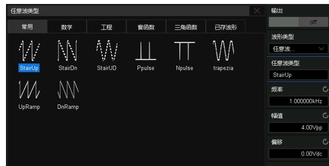
通过 USB Host 接入 25 MHz USB 任意波形发生器模块，集成正弦波、方波、三角波、脉冲波、噪声、直流以及 45 种内建任意波，用户也可通过 EasyWave 上位机软件编辑任意波形。
