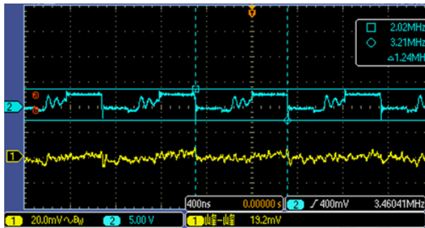
VIN = 2.7V, ILOAD = 0.1A Waveform
