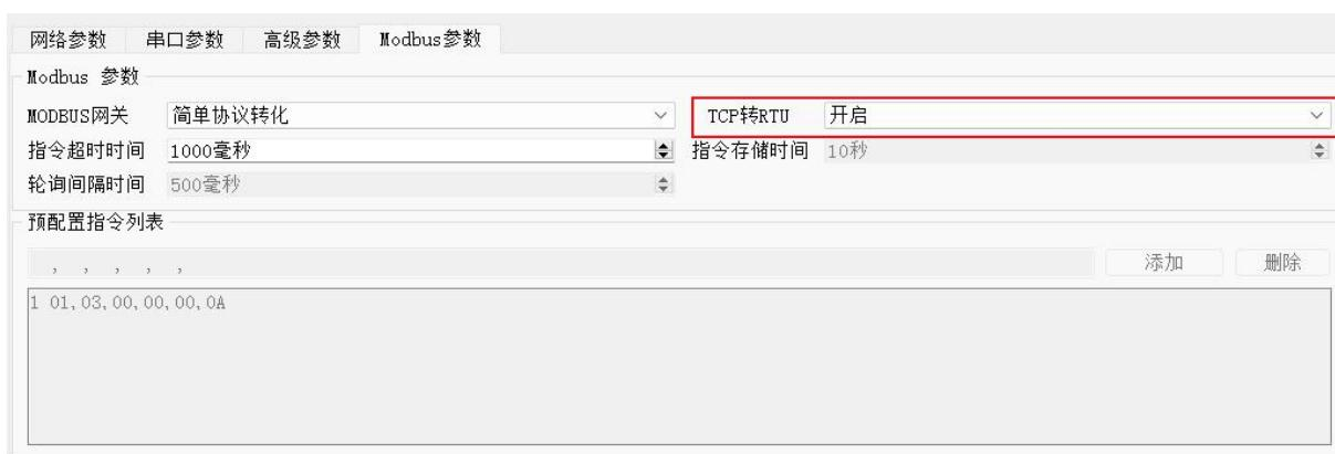
**开启：**将 Modbus RTU 协议与 Modbus TCP 协议进行互转，非 Modbus 数据（RTU/TCP）抛弃不进行转换。
