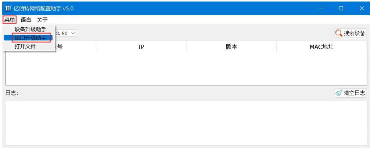
第三步：先连接电脑的 USB 端口，在弹出的“串口升级助手”对话框中，选择对应的端口号，点击“打开串口”；
