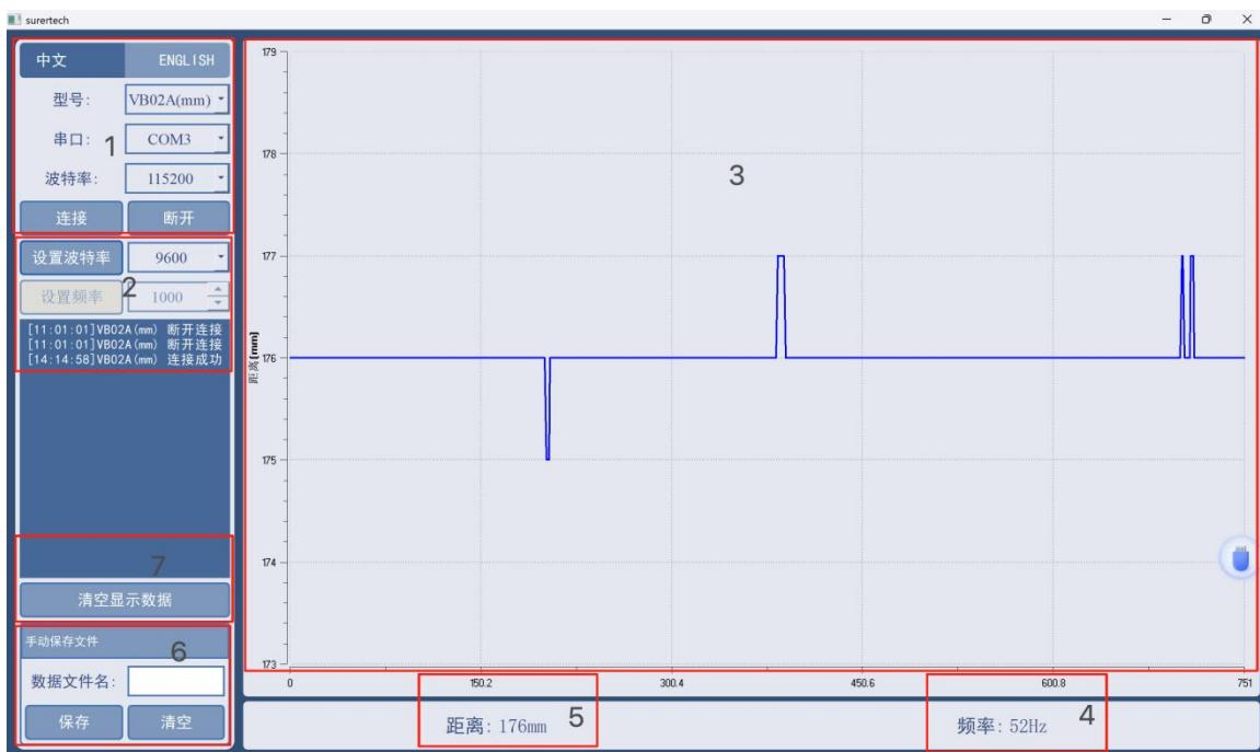
区域1: 设置相应型号串口波特率等参数, 点击断开再点击连接
