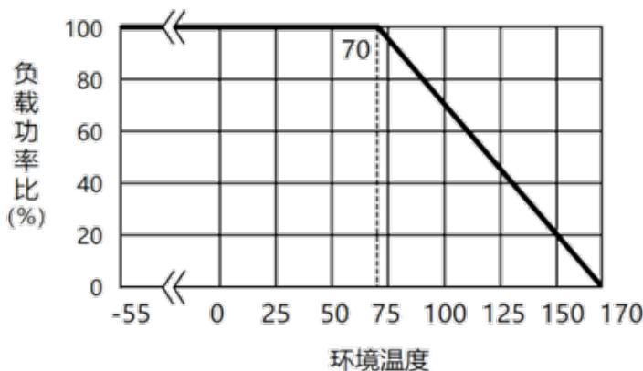
操作温度范围-50~+170°C， 电阻温度达到70°C时降功率示意图
