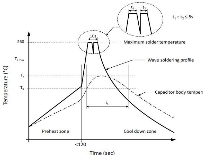
$T_s$ : 波峰焊接时电器本体最大受热温度
