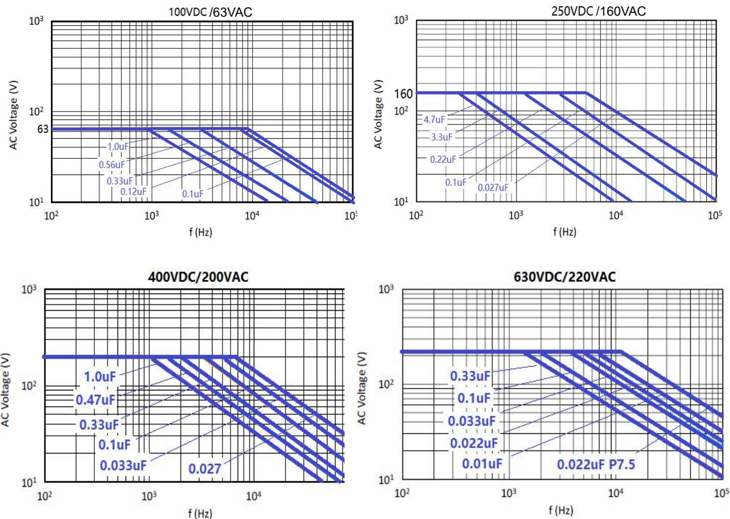
注意：1. 曲线图典型值在施压电压系正弦波形，环境温度 $\leq 85^\circ C$ ，电容器内部温升 $\Delta T=15^\circ C$ 条件下试验。
