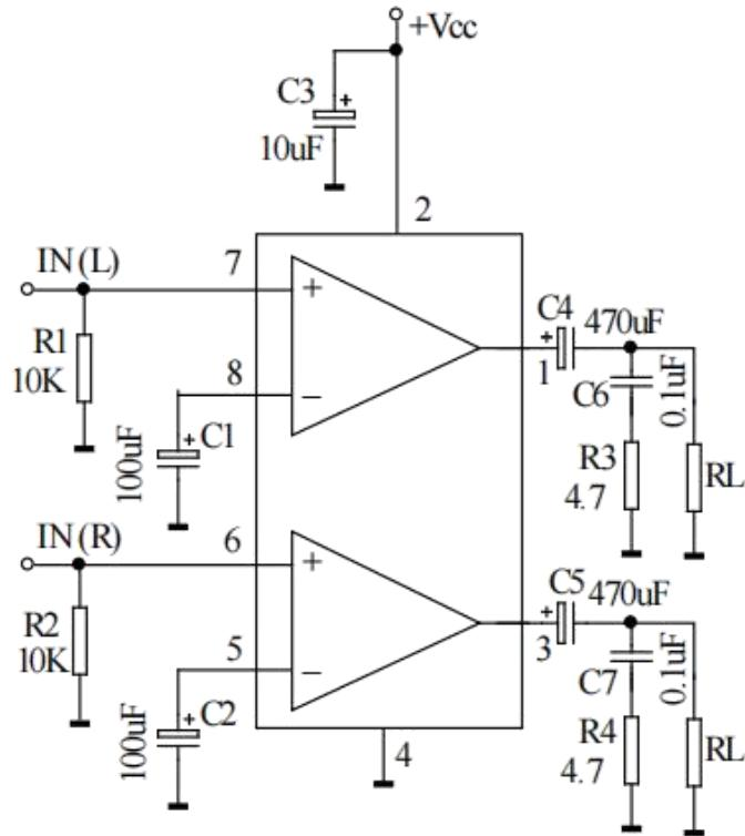
桥式应用测试图 (电阻单位:  $\Omega$ )
