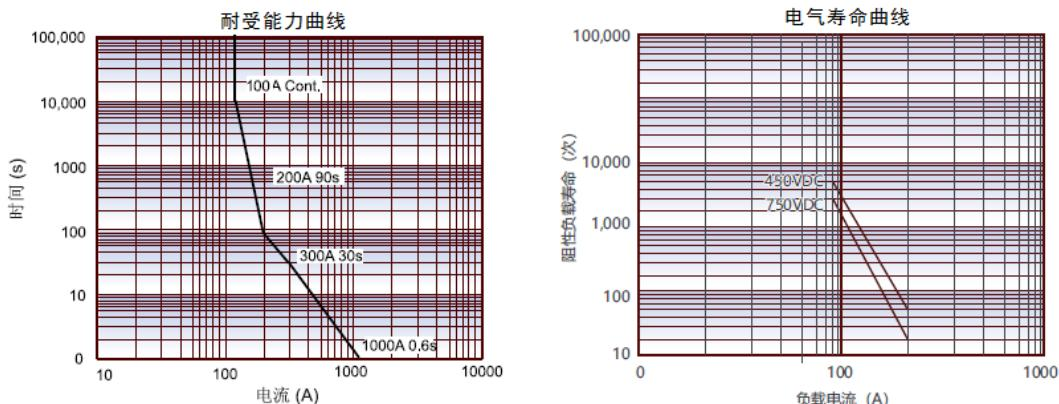
备注: 1)耐受电流测试在连接导线截面积 $\geq 35\text{mm}^2$ 条件下, 数据仅作参考, 请勿直接用于选择熔断器。
