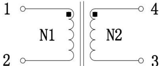
**绕线结构表 Winding Structure Diagram**
