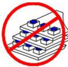
4、不可接触和使用天那水、三氯乙稀、丙酮、硫化物、钠离子及酸、碱、盐等物质，这样会造成镀银层氧化及荧光粉硫化。致使发光二极管发光颜色变淡、亮度变暗等现象发生。
