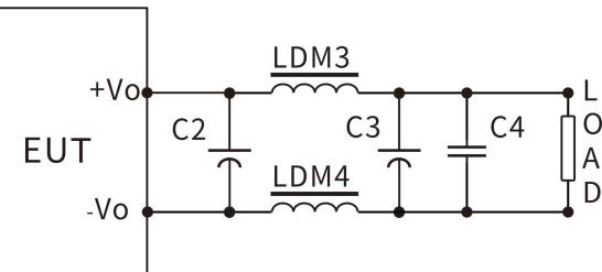
对纹波&噪声要求一般时，外围推荐仅使用 C2、C5 即可；对纹波&噪声要求严格时；推荐使用上图电路。
