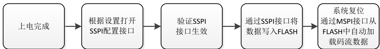
图 2-9-9 配置模式阶段启动 SSPI 的流程
