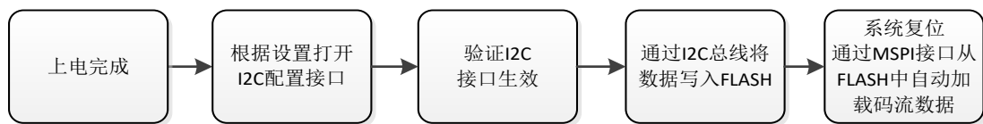
图 2-9-12 配置模式阶段启动 I2C 的流程
