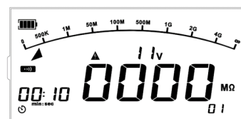
图11.4 表笔线短路测试界面
