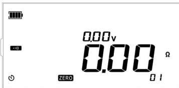
图13.17 表笔短接测量归零界面
