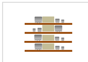
电容插件后的线路板不叠加堆放
