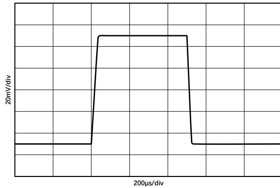
图 1.9.1. 小信号阶跃响应 @ V_S = 5\text{V}
