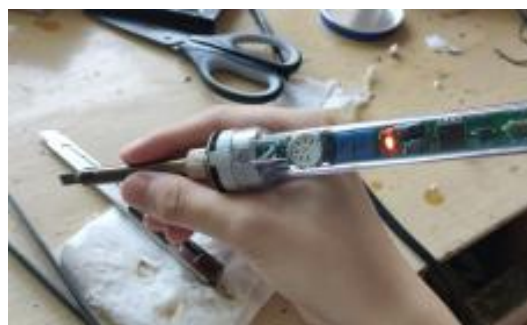
图4-4 电烙铁错误操作手势
