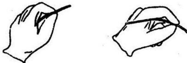
图4-6 焊锡丝正确握法
