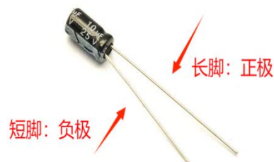
图4-22 10uf 25v电解电容示意图
