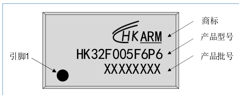
图 7-4 TSSOP20 HK32F005F6P6 丝印示例
