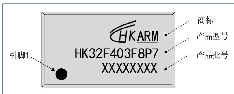
图 7-21 TSSOP20 HK32F403F8P7 丝印示例
