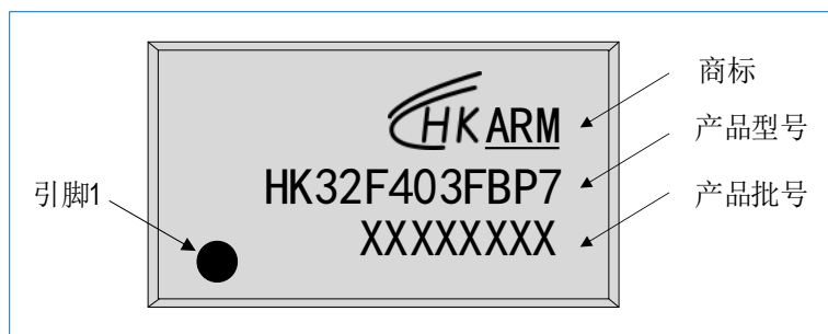
图 7-20 TSSOP20 HK32F403FBP7 丝印示例
