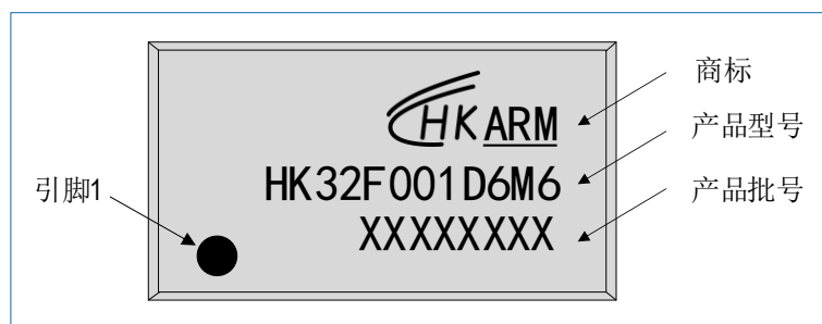
图 8-3 SOP16 HK32F001D6M6 丝印示例
