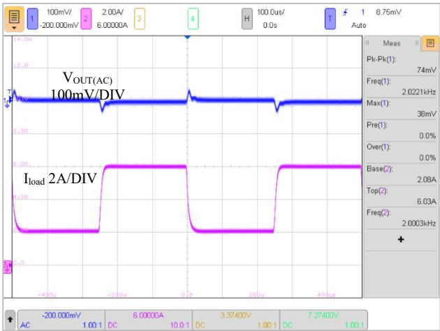
图 8: 5VIN 输出动态(1.2VOUT, CCM 模式, 2A -> 6A 负载跳变, 2A/μS, 频率 2kHz)
