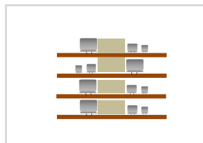
电容插件后的线路板不叠加堆放
