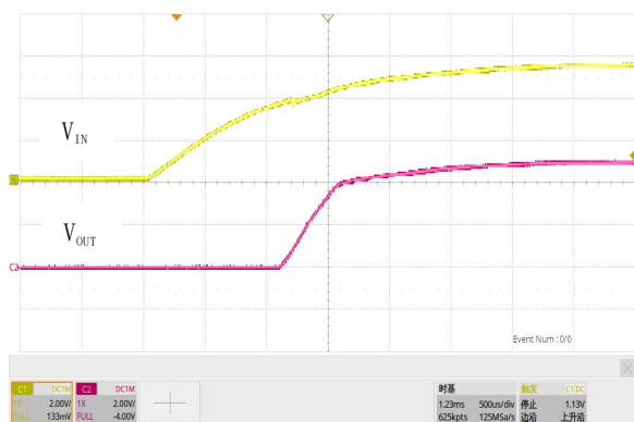
图 18. 软启动, V_{IN}=5.5V , V_{OUT}=5.0V , I_{OUT}=1.5A
