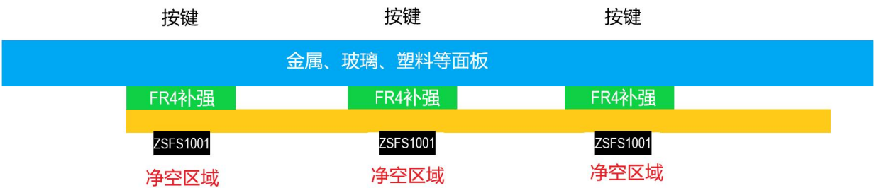
图 11 ZSFS1001 FPC 多按键结构图
